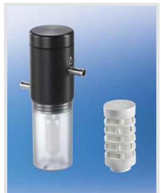
Överfyllnadsskydd med hydrofobiskt bakterie- och virusfilter
